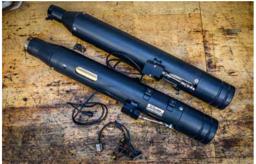
KessTech-ESE-Anlage für die Road King im matten Schwarz mit der Endkappe „Billet Round“. Die Montage ist im Vergleich mit die einfachste und narrensicherste
