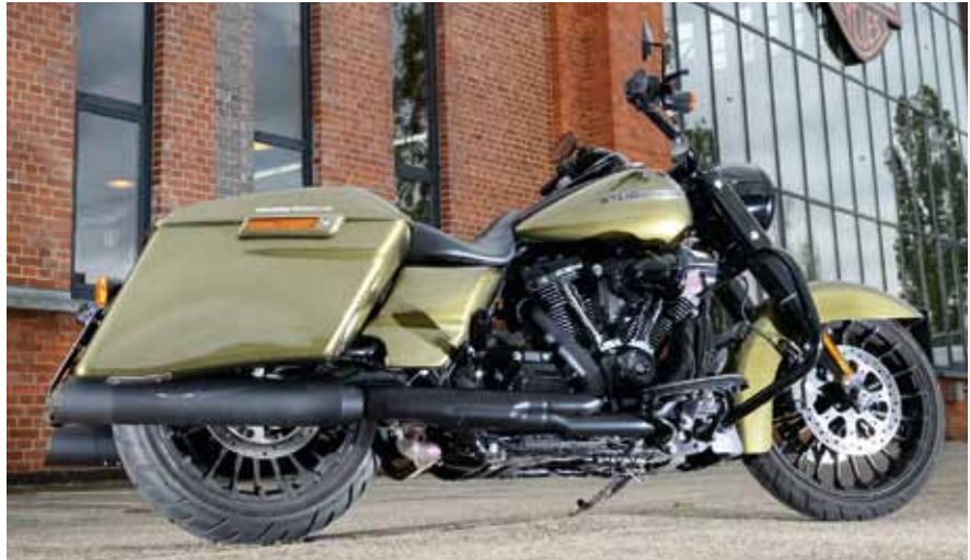
Optisches Highlight der Penzl V2 ist die schräge Endkappe C-S in mattschwarz. Die Montage ist sehr aufwendig, da u.a Bowdenzüge konfektioniert werden müssen
