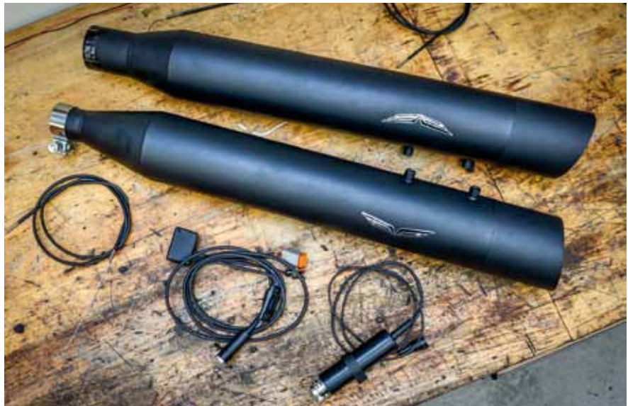
Optisches Highlight der Penzl V2 ist die schräge Endkappe C-S in mattschwarz. Die Montage ist sehr aufwendig, da u.a Bowdenzüge konfektioniert werden müssen
