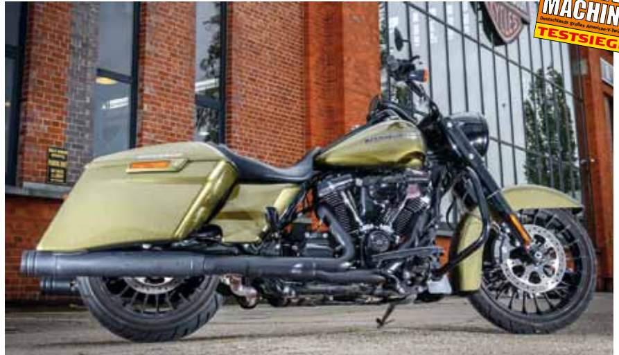
KessTech-ESE-Anlage für die Road King im matten Schwarz mit der Endkappe „Billet Round“. Die Montage ist im Vergleich mit die einfachste und narrensicherste
